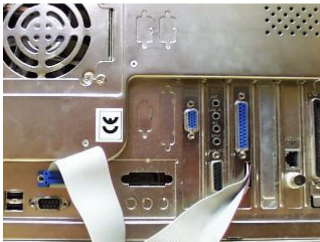
Obrázok 1.2.2.3. – Pohľad na zadný panel počítača po inštalácii analyzátoru
