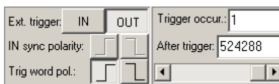
Obrázok 4.3.1.1. – Časť panelu spúšťacieho systému ovládajúca spúšťanie
