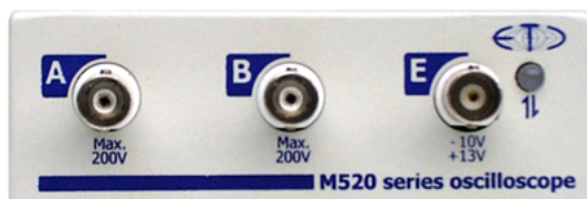
Obrázok 3.1.1. – Čelný panel prístroja
