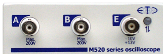
Obrázok 3.1.1. – Čelný panel prístroja
